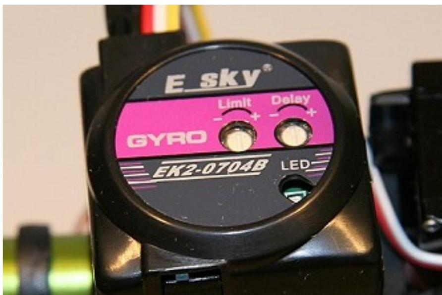
Die Stabilisierung des Hecks übernimmt jetzt der neue EK2-07048 Gyro (Headlock Gyro). Die Servos wurden in einer neuen Version überarbeitet (4 x 7.5g Digital Servos -EK2-050). Auch die Taumelscheibe wurde neu gestaltet. Das 120° E-CCPM Taumelscheiben Anlenkungssystem beinhaltet als Kernelement nun eine Alu-Taumelscheibe. Die Stabilität der Landekufen wurde in der neuen
