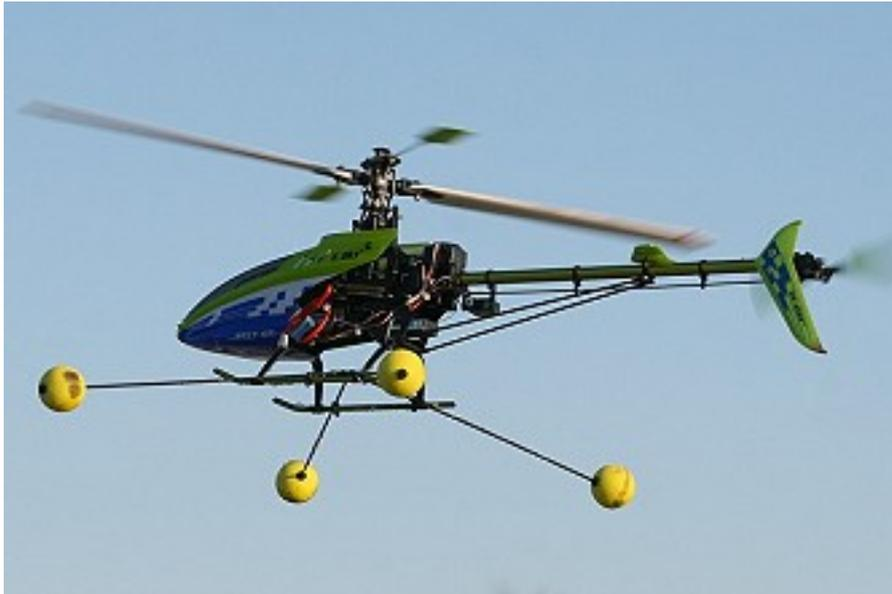
Im 3D-Modus sollte unser Testmodell nun erstmalig eingesetzt werden. Beginnend mit einem Rundflug und dem Abfliegen einer Acht, folgen Drehungen um die eigene Achse und ein erster Looping. Das Heck zeigt bei allen Flugmanövern keinerlei Zucken im Flug. Der Gyro kann somit überzeugen.
